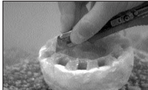
Inicialmente se crea un módulo base practicando cajas de ensamblaje sobre la resina en fase de gel consistente para ser cortado con la intervención de un cutter
