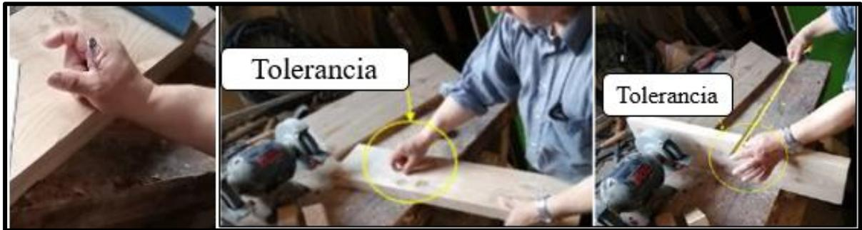
**Figura 8.** Unidad de medida no convencional: “la tolerancia”. Fuente: elaboración de los autores con base en el trabajo de campo.
