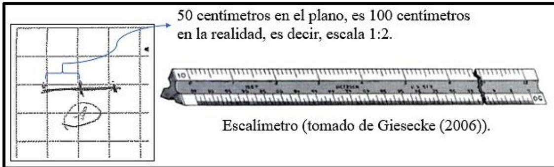
**Figura 9.** Uso del escalímetro para medir e interpretar planos. Fuente: elaboración de los autores con base en el trabajo de campo y Giesecke (2006).
