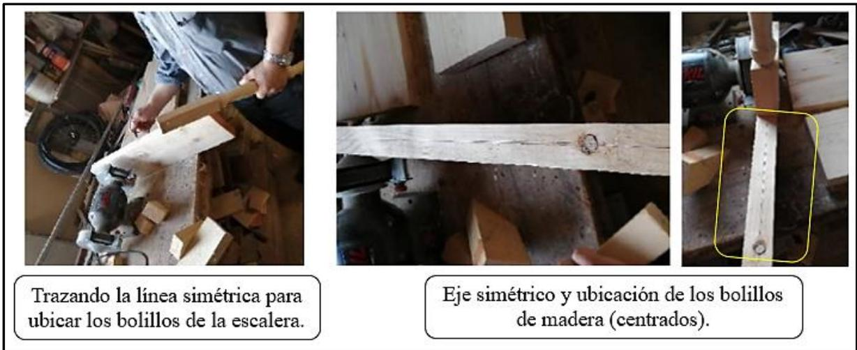
**Figura 4.** Ubicación de las piezas sobre el eje (eje de simetría). Fuente: elaboración de los autores con base en el trabajo de campo.
