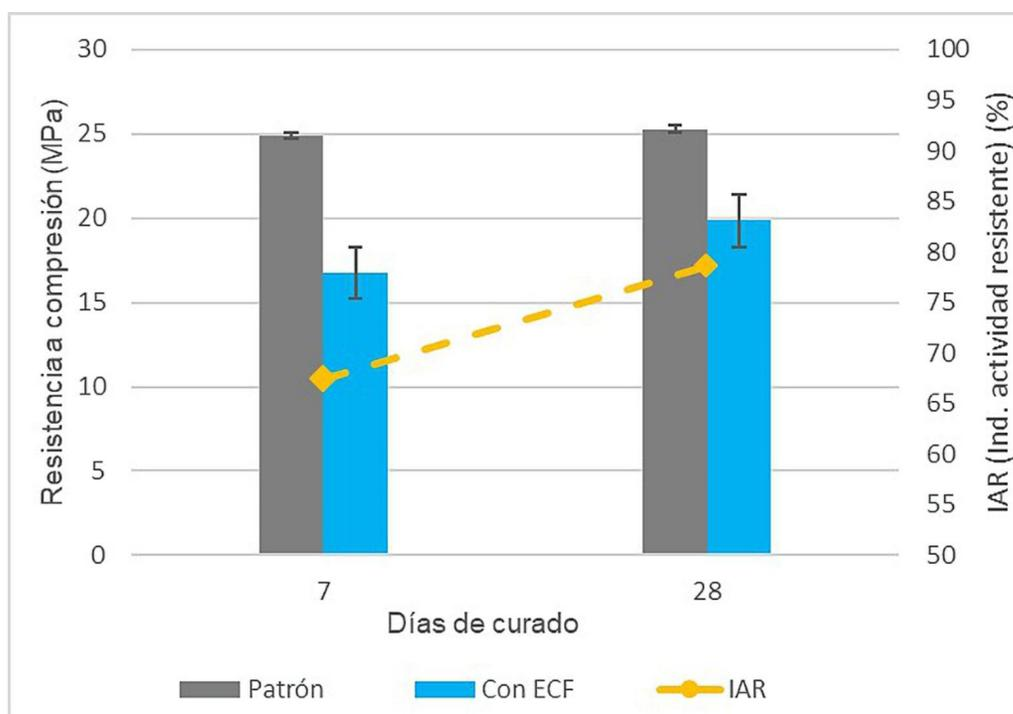
Figura 5. Resistencia a compresión de morteros ensayados, de acuerdo a la norma ASTM C311
