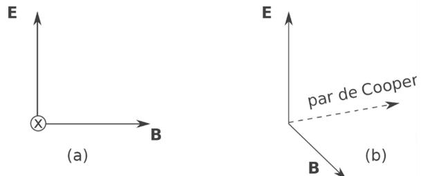
**Figura 2.** En (a) se representan los campos eléctricos y magnéticos de una onda electromagnética que se propaga a la velocidad de la luz en la dirección de entrada a la hoja. En (b) se muestra una onda electromagnética propagándose dentro de un condensado de pares de Cooper, en la dirección de la componente ilustrada del par de Cooper.
