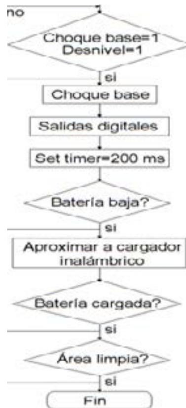
Figura 4. Diagrama de flujo de algoritmo principal
