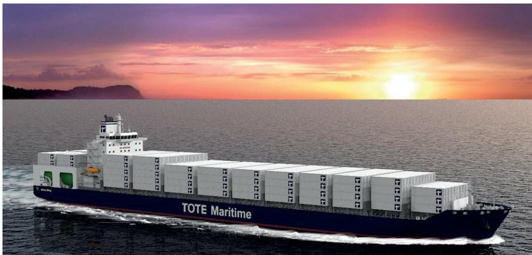
Figura 2. Fotografía de uno de los mayores barcos que para su propulsión usará como combustible gas natural licuado (LGH) y será una idea de TOTE Shipholdings para TOTE Maritime Division. Fuente: <http://www.galemenergy.com.mx/wp-content/uploads/2017/09/barco-petrolero.jpg>porcionar.
