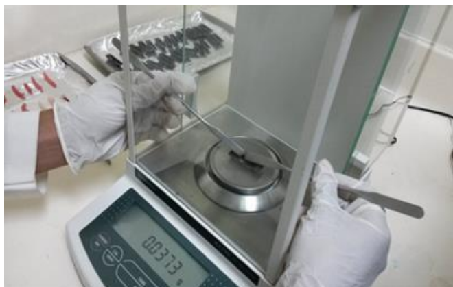
Figura 2. Colocación de submuestra en crisol metálico
