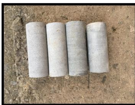
Ilustración 5. Testigos o probetas cilíndricas
