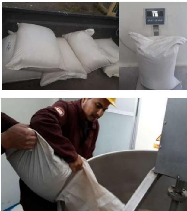
Figura 4: Pesaje de las libras y ubicación en la lavadora en este caso 5 quintales de 100lb
