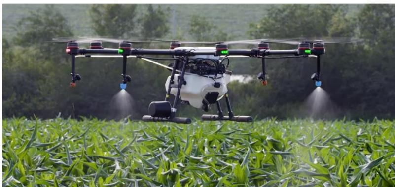
Figura 1. Avión no tripulado para uso agrícola
