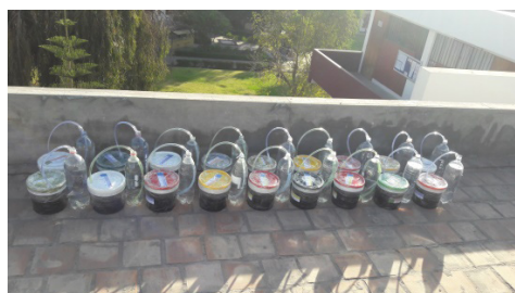
Figura 3. Fotos de los biodigestores tomada el mismo día que se sellaron y comenzó la fermentación anaeróbica
