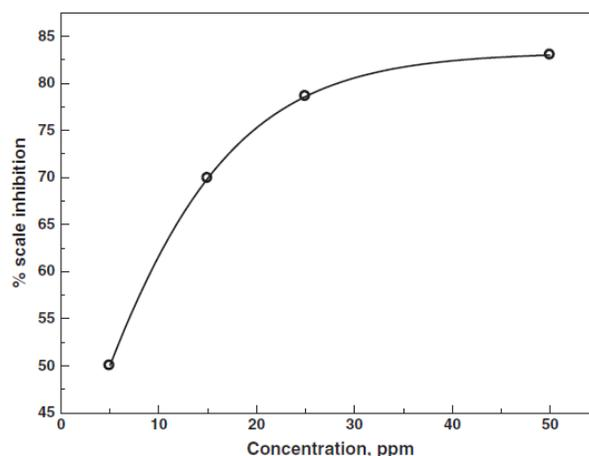
**Figura 7.** Variación del porcentaje de inhibición de incrustaciones con respecto a la concentración del extracto de hojas de oliva
