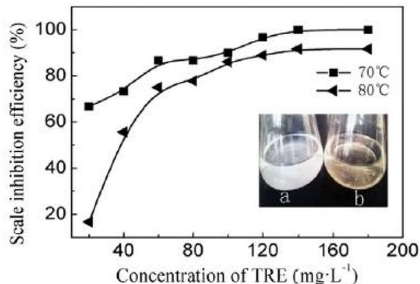
**Figura 6.** Efecto de la concentración de las hojas de tabaco y temperatura sobre la eficiencia de inhibición de incrustación. En las imágenes (a) depósitos de incrustaciones en blanco y (b) salmuera artificial con 140 ppm de extracto de tabaco
