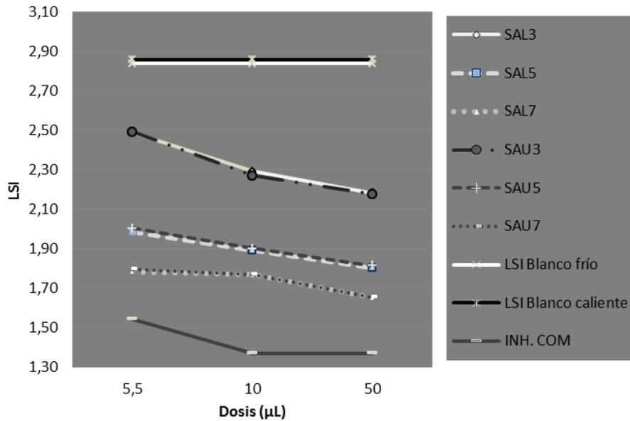
**Figura 5.** Comparación de los Índices de Saturación de Langelier para las muestras de agua con inhibidores experimentales, comercial y blancos (frío y caliente)
