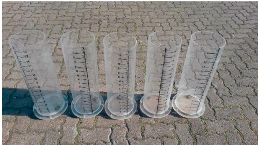
Figura 2. Cilindros graduados utilizados para la cuantificación del volumen vertido por el techo verde [9].
