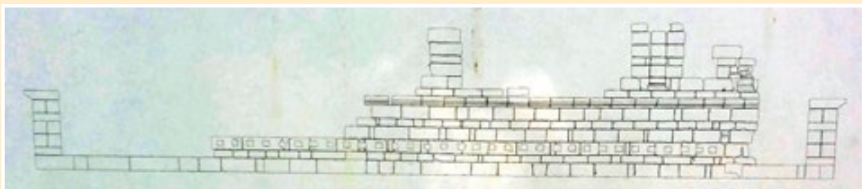
Fig. 74. Bouleuterion de Alabanda. Dibujo del alzado representado en el cartel informativo del sitio arqueológico. Recuerda mucho a la obra del castillo de Marbella, salvo por la menor utilización de tizones.
