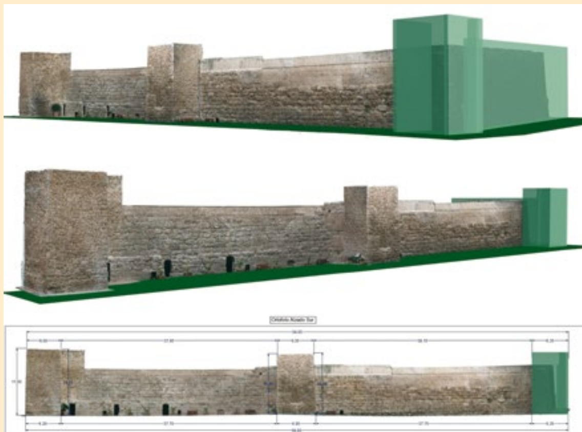
Fig. 9. Arriba, perspectivas de los paramentos sur del castillo con la posible ubicación de la perdida torre sureste. Abajo, ortofoto acotada. La distancia entre torres equidistaría unos 38 metros.
