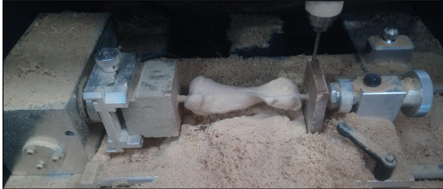
Figura 14. Fósil construido en la estación de prototipado CAM.
