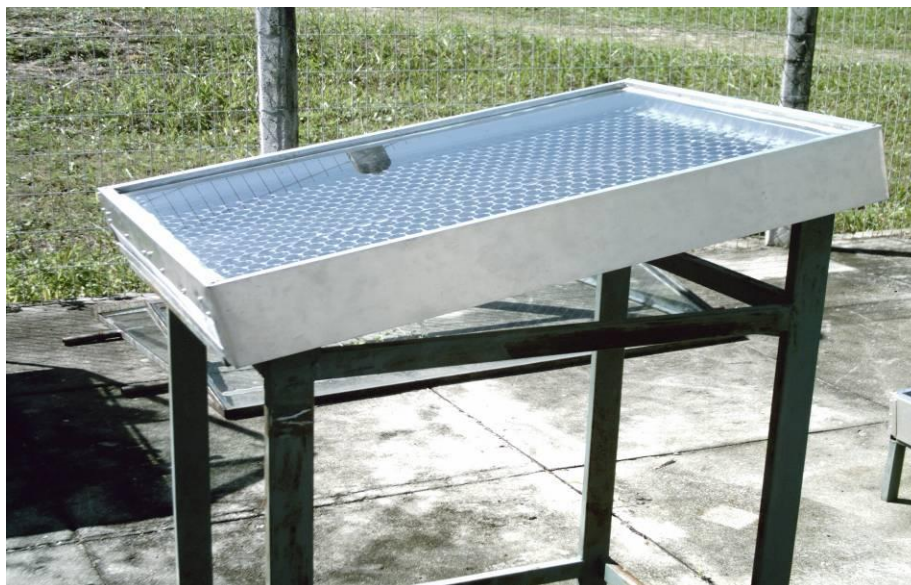
FIGURA 2 – Configuração do secador solar de radiação direta (SRD).
