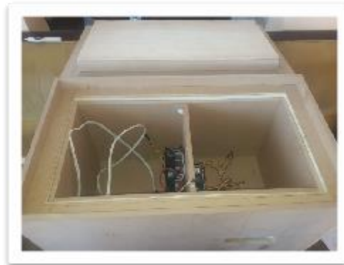
Figura 3 Módulo de refrigeración con aislamiento térmico
