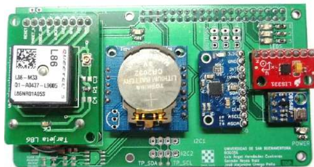
FIG. 4 Placa para integración de elementos de medición.
