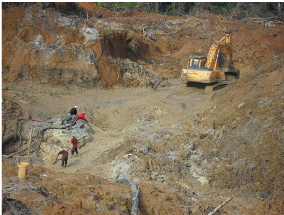
Figura 1 - Desmorte hidráulico de barranco co auxilio da retroescavadeira. Garimpo do Reinaldo (área de garimpagem "Manlobi"), Distrito de Sipaliwini, Surinam.
