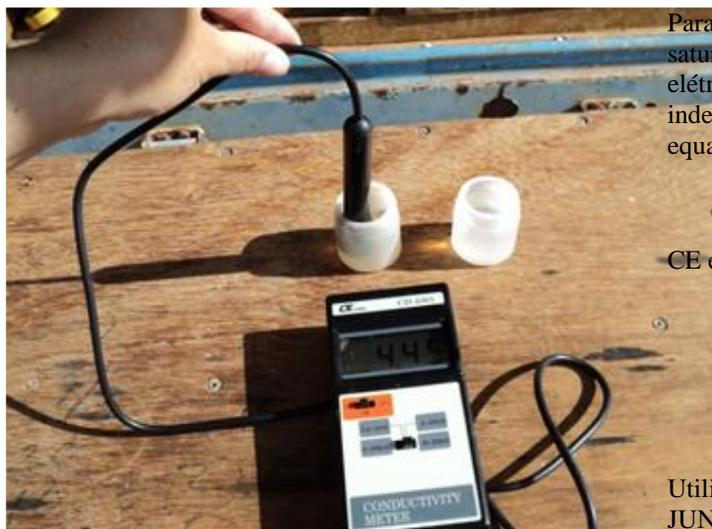
Figura 1: Medição da condutividade elétrica da água de irrigação, Mossoró-RN, UFERSA, 2012.
