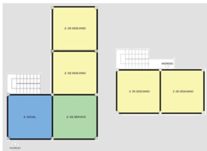
Figura 9. Esquema funcional de la vivienda
