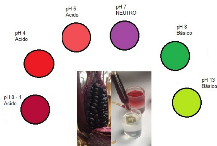
Figura 2: Fotografías del maíz morado utilizado con su extracto correspondiente. Incluye la gama de colores que adopta el indicador según el pH de las soluciones patón.
