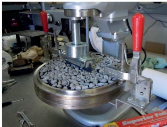
Figura 6. Barrido final de una muestra del ensayo de barrido.
