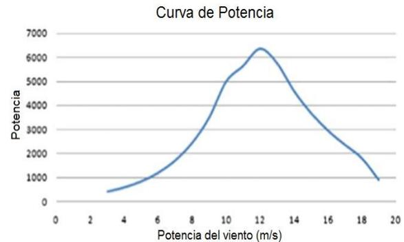
**Figura 3:** Curva de potencia de un generador de 5 kW.
