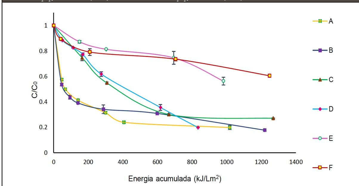
Los resultados obtenidos en la **Figura 7** muestran que la FLX no sufre fotólisis, la combinación de la FLX con una [H<sub>2</sub>O<sub>2</sub>] de 1000 μM y luz solar (Solar/H<sub>2</sub>O<sub>2</sub>) mejora la degradación (% remoción 17%) en comparación con la fotólisis. De acuerdo a éstos resultados, la ruta de degradación por el acople FFS es principalmente por vía radicalaria gracias a la reacción Fenton con radiación solar.
