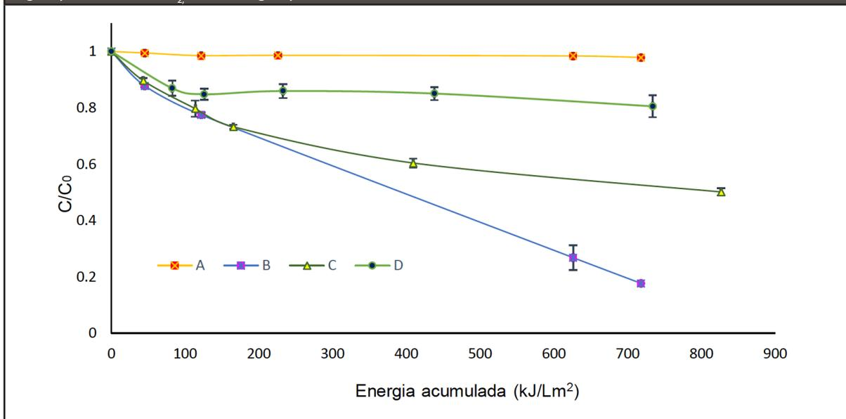
**Figura 4.** Degradación de 40 mg L<sup>-1</sup> de FLX con [TiO<sub>2</sub>]= 50 mg L<sup>-1</sup> y luz solar con A) Sin [H<sub>2</sub>O<sub>2</sub>]. B) [H<sub>2</sub>O<sub>2</sub>]= 1000 μM. C) [H<sub>2</sub>O<sub>2</sub>]= 4409 μM. Mineralización con [TiO<sub>2</sub>]= 500 mg L<sup>-1</sup> y luz solar con D) [H<sub>2</sub>O<sub>2</sub>]= 1000 μM
