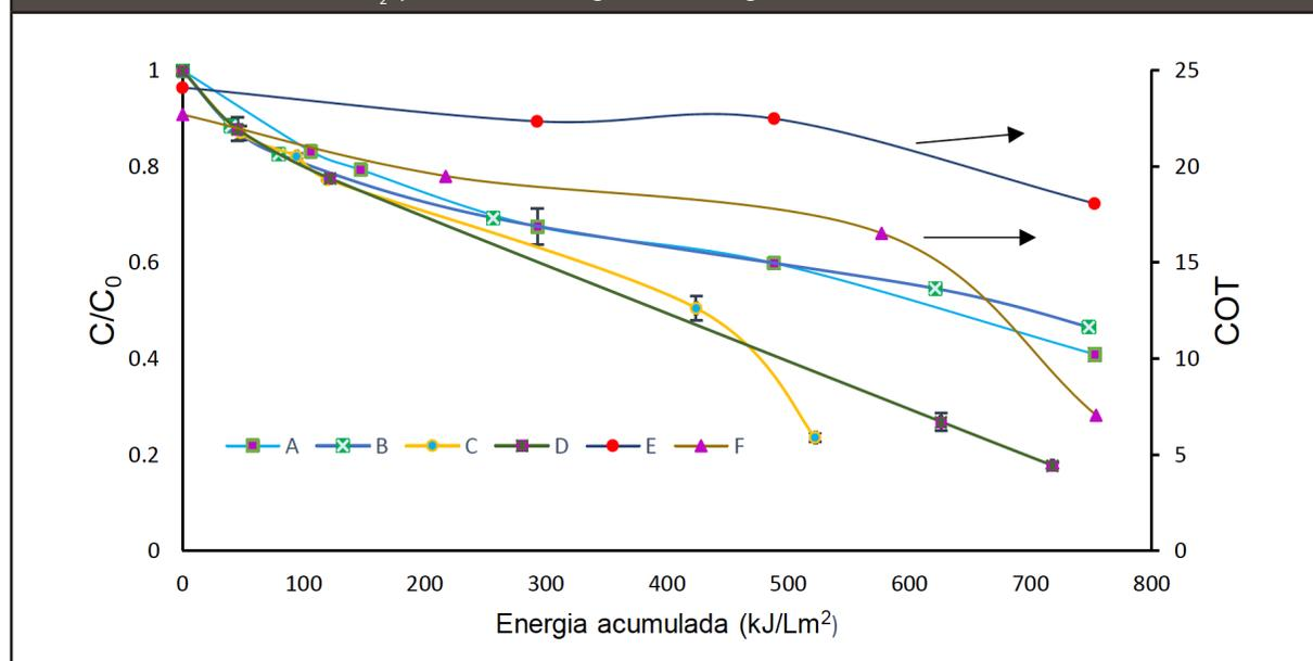
**Figura 3.** Degradación de 40 mg L<sup>-1</sup> de FLX con [TiO<sub>2</sub>]= 500 mg L<sup>-1</sup> por A) adsorción. B) TiO<sub>2</sub> y luz solar. C) TiO<sub>2</sub> [IPA]= 40 mg L<sup>-1</sup> y luz solar. D) TiO<sub>2</sub> [KI]= 40 mg L<sup>-1</sup> y luz solar
