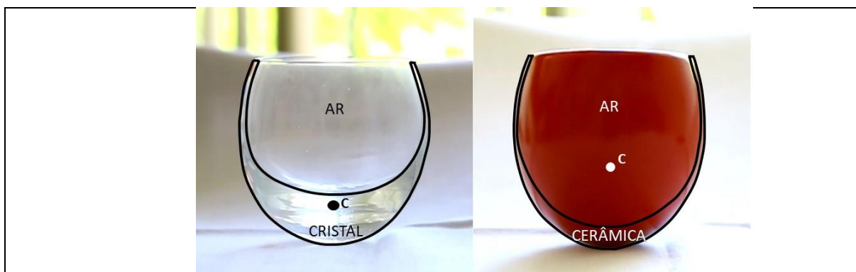
Fig. 5 – As diferenças nas distribuições de massa entre a caneca de cristal e a de cerâmica podem ser evidenciadas nessa figura, que superpõe às fotografias os traços limítrofes aos diedros cristal-ar e cerâmica-ar. Fonte: os autores.
