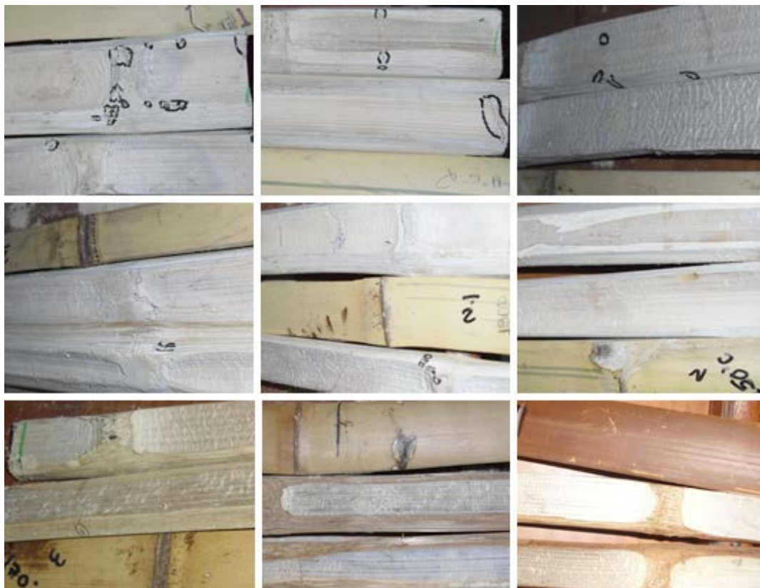
FIGURA 6. Ataque de Dinoderus minutus a especímenes de Bambusa vulgaris vittata sometidos a tratamientos por temperatura.
