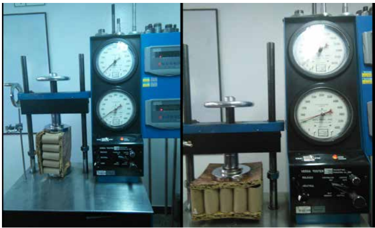
Figura 11. Equipos utilizados (prensa hidráulica) para pruebas de resistencia de carga horizontal y carga vertical Fuente: elaboración propia, 2017, CC BY.
