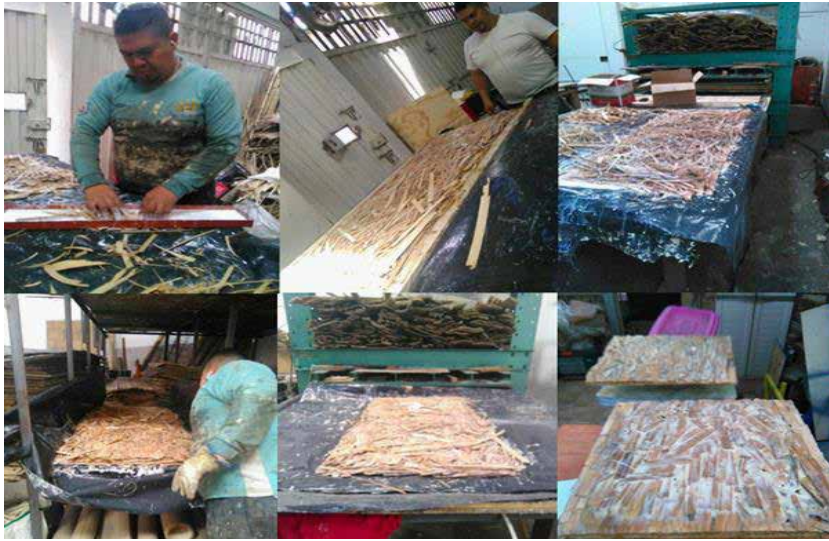
Figura 7. Proceso de fabricación del tablero OSB, empresa Muiskey Fuente: elaboración propia, 2017, CC BY-ND.
