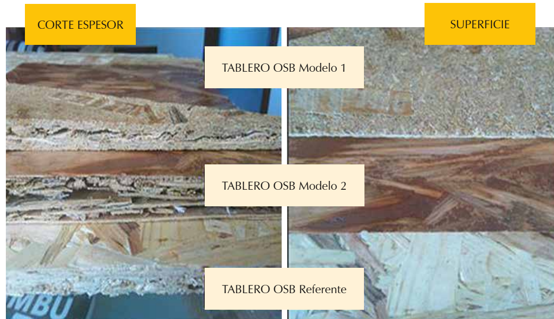
➤ Figura 14. Composición de los tableros OSB del referente y las propuestas 1 y 2
