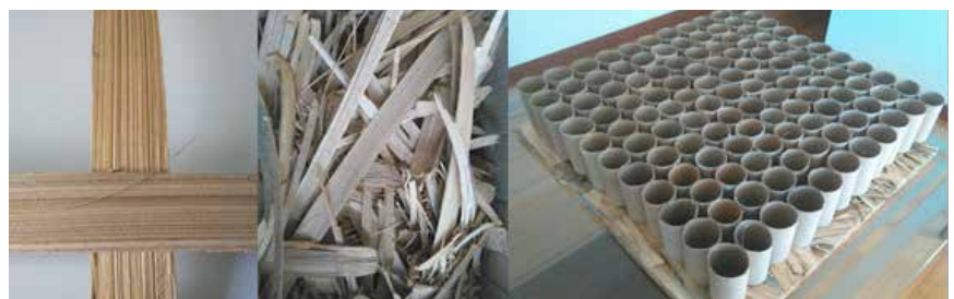
Figura 6. Fibra de guadua reciclada y tubos de cartón reciclados Fuente: elaboración propia, 2017, CC BY-ND.
