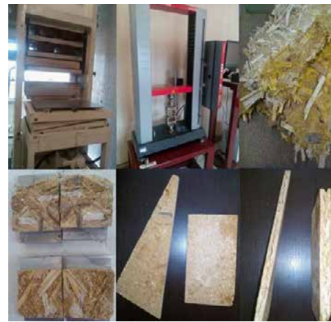
Figura 12. Proceso de fabricación de probetas y tablero Fuente: Primadera SAS, 2017.
