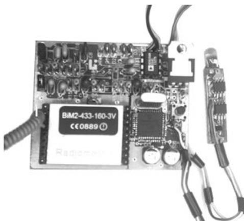
**Figura 3.** *Nodo sensor para coleta e transmissão dos dados as ERBF.* (Sensor node to collect and transmit data as ERBF).
