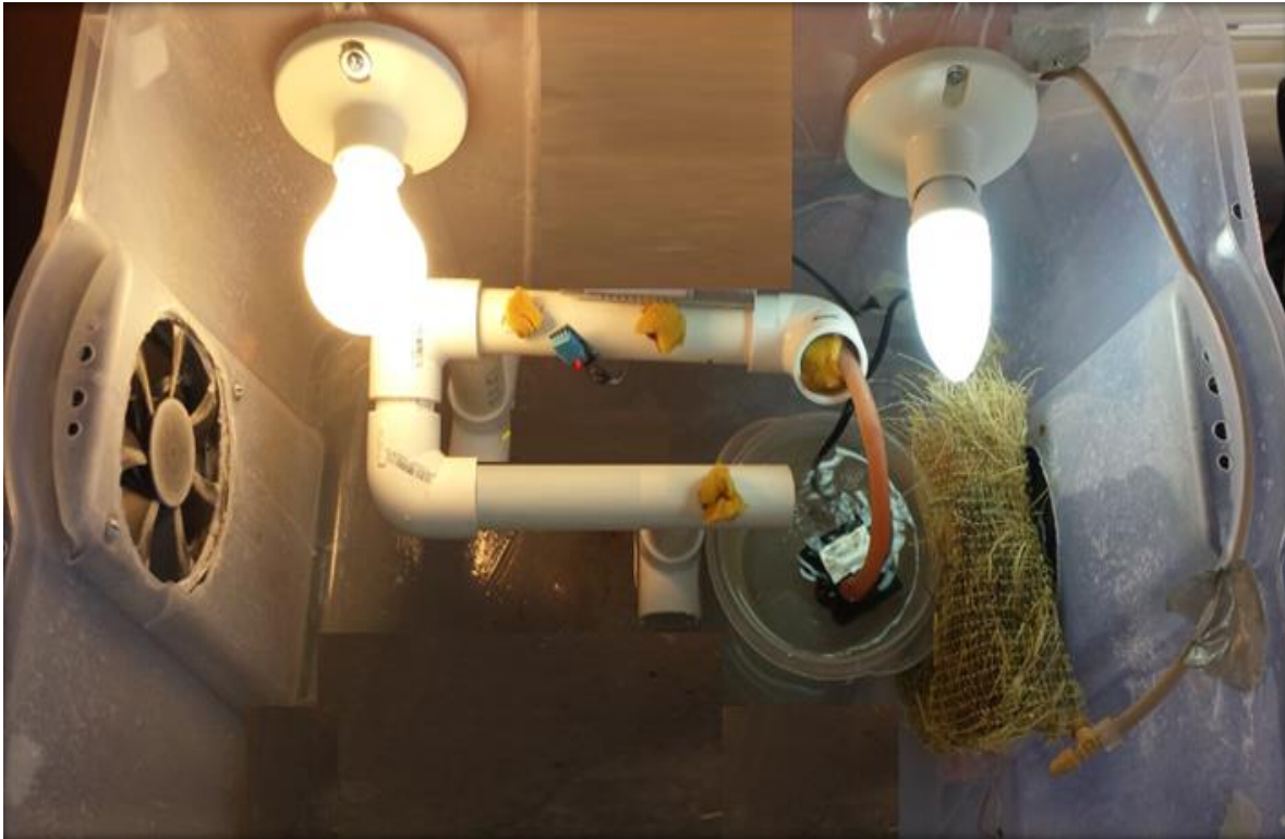
Figura 7.- Prototipo de invernadero y sistema hidropónico
