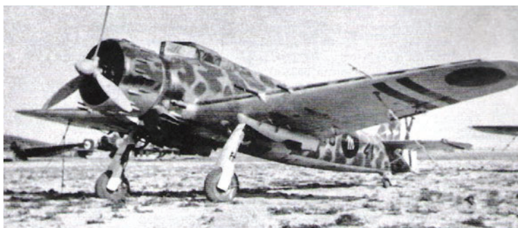
Avión de caza Breda Ba.65, de la 65ª Squadriglia, matrícula 16-41, modelo similar al que abatió al Katiuska sobre Ágreda. En las alas pueden observarse la cuatro ametralladoras Breda SAFAT con que estaba dotado: dos de 7,7 mm y dos de 12,7 mm (SHYCEA)
