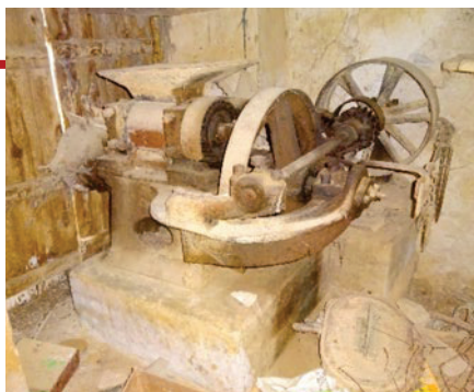
Moldeadora de ladrillos huecos y rasillas.
