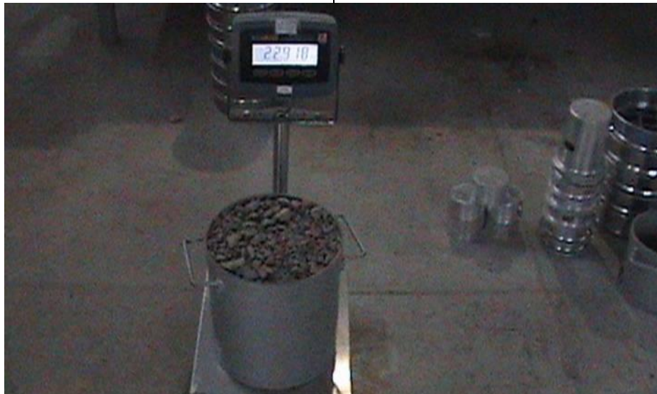
Figura 4. Equipo para determinar la masa volumétrica de los materiales bascula y molde volumétrico.
