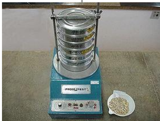
Figura 1. Equipo ro-tap para obtener una curva granulométrica.
