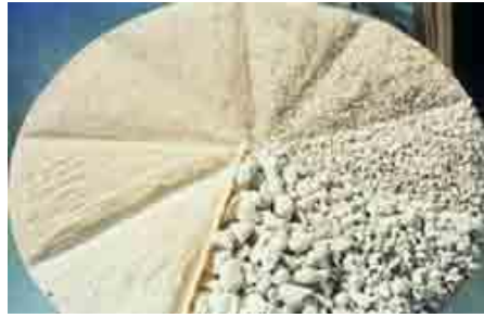
Figura 3. Separación adecuada de los materiales en las diferentes mallas.
