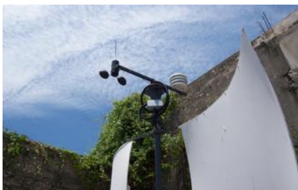
Figura 35 Anemómetro y veleta en la parte más alta de la base tubular.
