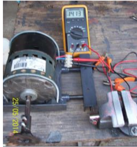
Figura 23 Aumentan las rpm y aumenta el voltaje de salida del generador.
