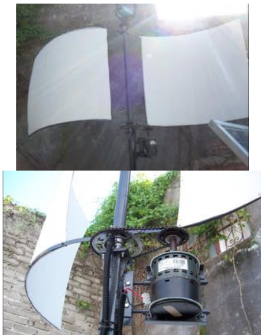
Figura 16 El rotor Savonius terminado con generador eléctrico acoplado por transmisión mecánica de cadena-corona-piñón.
