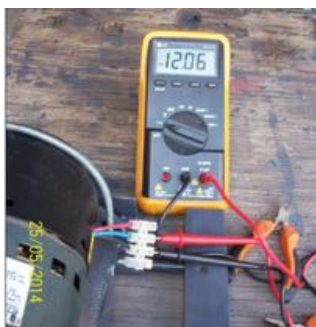
Figura 22 Respuesta del generador 12VCA a 35 rpm.
