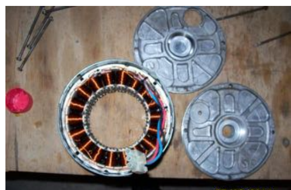
Figura 19 Estator del generador.
