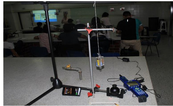
Fig. 17. Montaje Laboratorio Péndulo Simple
