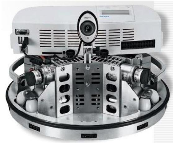
Figura 1. Plataforma *Robotino*
