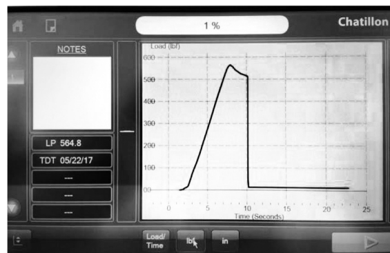
Figura 4. Ejemplo de tensión aplicada a una probeta.
