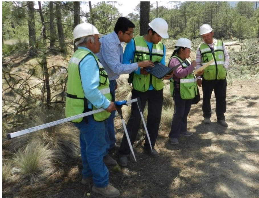
FIGURA 4. Forcípula electrónica Haglöf y sistema de control para la cubicación automática de madera en rollo.
