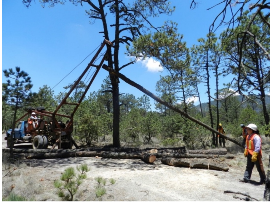
FIGURA 3. Arrime semisuspendido del fuste limpio.
