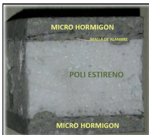
Figura 1. Estructura del sistema constructivo HORMYPOL.
