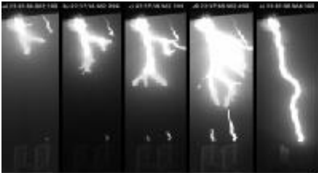
FIGURA 5. Sequência de imagens obtida por uma câmera de alta velocidade ilustrando a conexão de um raio descendente com o líder ascendente conectivo, a partir do sistema de proteção contra descargas atmosféricas de dois edifícios de 14 andares na cidade de São Paulo. Imagem reproduzida da referência [25].
