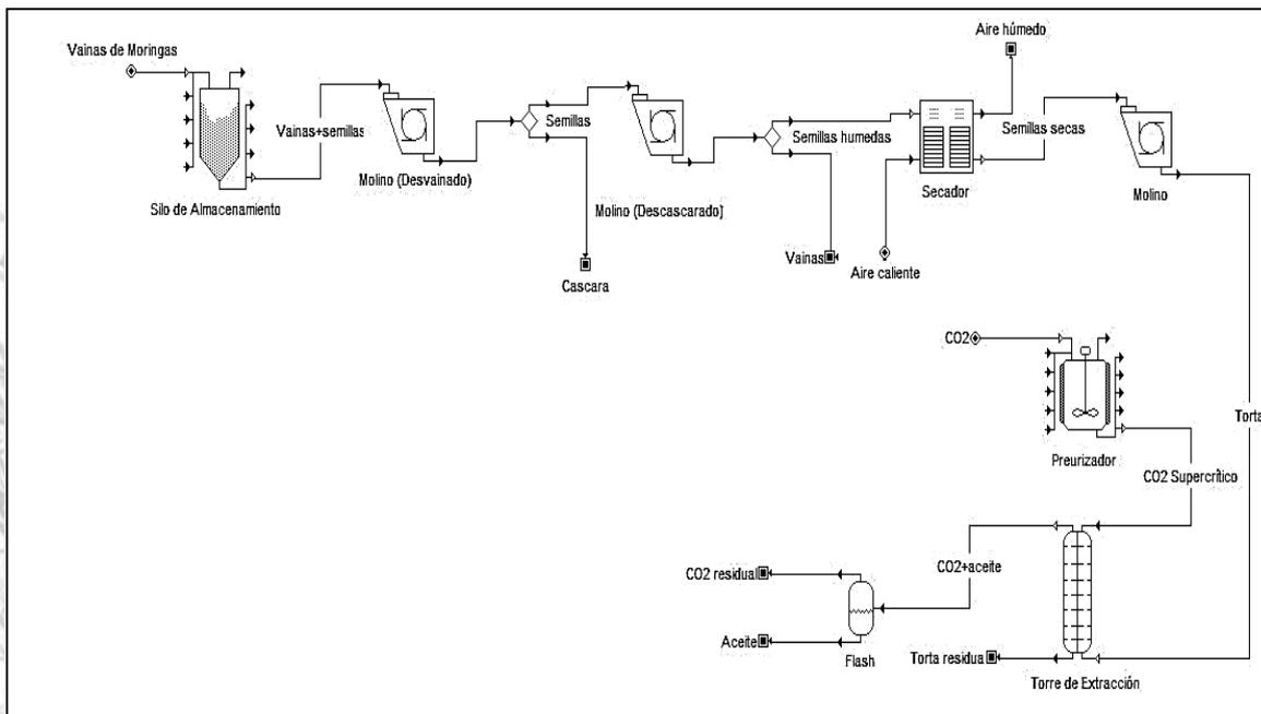
Figura 1. diagrama de flujo del proceso de extracción de aceites esenciales empleando CO<sub>2</sub> supercrítico.
