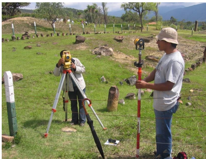
Figura 2. Levantamiento topográfico con estación total en parque arqueológico Monquirá de Villa de Leyva. Fuente: Los autores.
