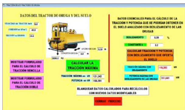
Figura 5. Formulario 3 para el cálculo de la tracción en el tractor de oruga
