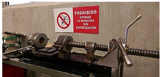
Figura 5. Máquina utilizada para sacar las briquetas del molde
