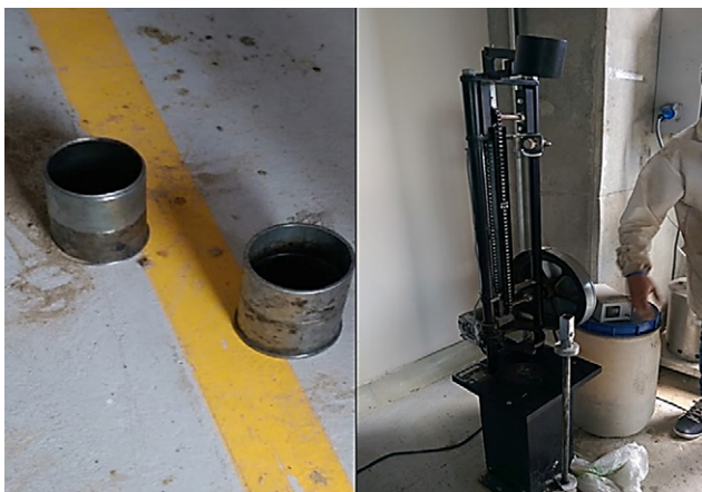
Figura 3. Moldes para fabricación de briquetas y máquina Humboldt para compactación automática Marshall
