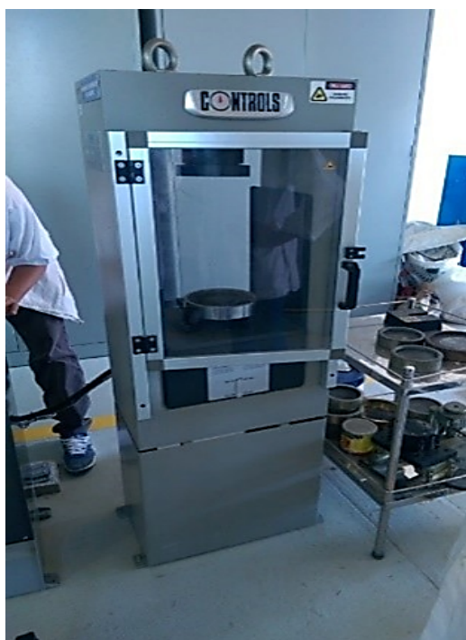
Figura 6. Máquina de compresión marca Controls modelo 04700/er
