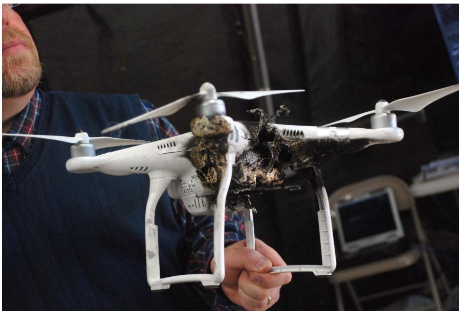
Figura 5. Efectos producidos por un arma láser sobre un dron
