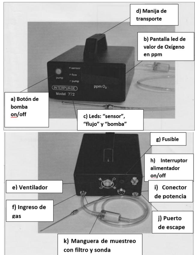
Figura 2. Medidor de oxígeno residual INTERPURGE Modelo 772. Vista frontal y posterior con los nombres de sus principales componentes. Fuente: [17].
