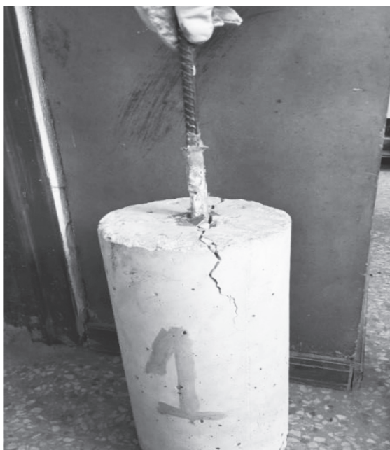
Ilustraciones 16-19. Descripción modos de falla cilindros de f'c = 14.0 MPa acero N°4.
