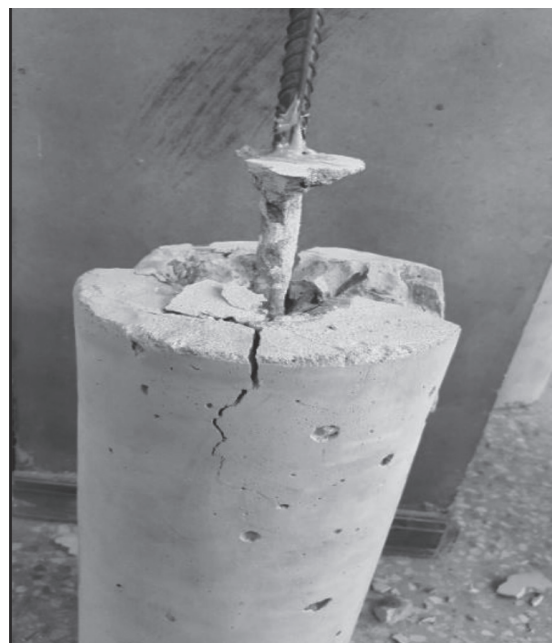
Ilustraciones 16-19. Descripción modos de falla cilindros de f'c = 14.0 MPa acero N°4.
