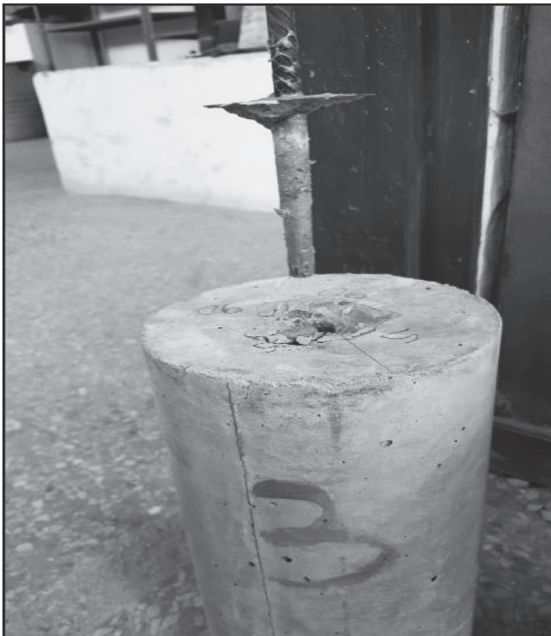
FALLA ANCLAJE / ADHESIVO; El adhesivo falla pero el cilindro no presenta fisuras. Fuente: Autor de la investigación.
