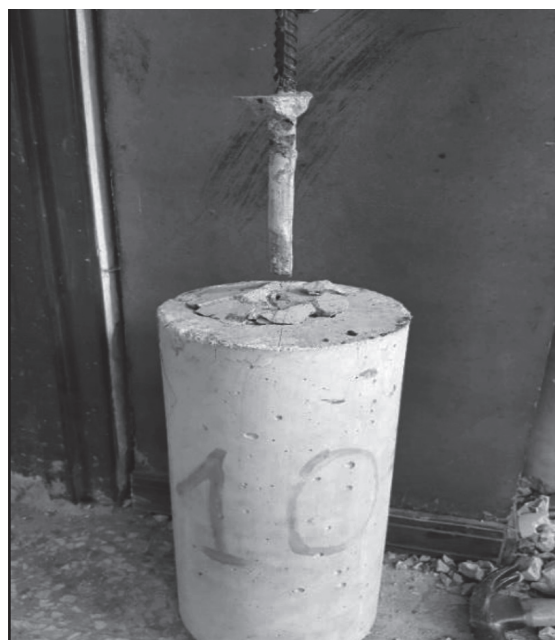
FALLA MIXTA; El adhesivo falla en conjunto con el concreto, pero no alcanza su máximo desempeño. Fuente: Autor de la investigación.
