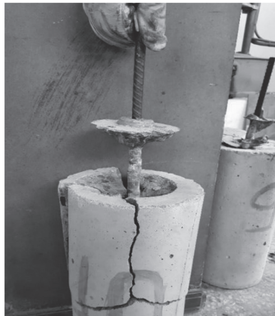
FALLA CONO; falla el concreto, el adhesivo alcanza su mayor desempeño. Fuente: Autor de la investigación.
