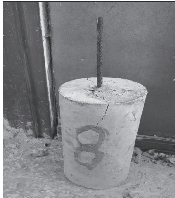
FALLA ADHESIVO / CONCRETO; El adhesivo falla y el cilindro presenta fisuras. Fuente: Autor de la investigación.
