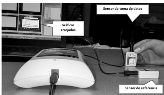
Figura 2. Ubicación de los sensores para la prueba estática.
