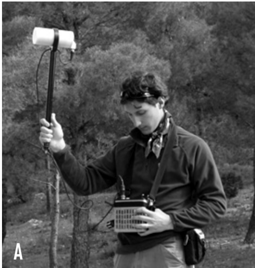
Figura 9. A) Magnetómetro OVERHAUSER GSM-9; B) Susceptómetro Exploranium Kappameter KT-9 y, en segundo plano las lavas almohadilladas sobre las que se usó.
