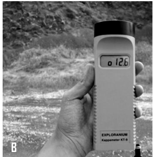
Figura 9. A) Magnetómetro OVERHAUSER GSM-9; B) Susceptómetro Exploranium Kappameter KT-9 y, en segundo plano las lavas almohadilladas sobre las que se usó.
