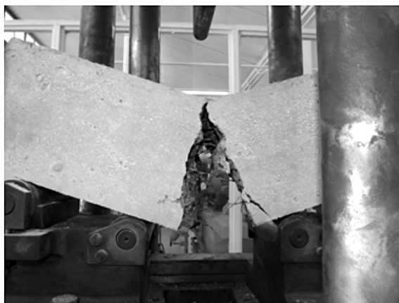
Figura 8. Muestra de concreto reforzado con fibras
