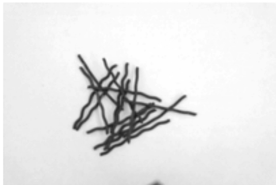
Figura 6. Fibras producidas a partir de alambre recocido
